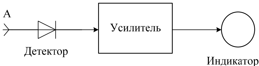
Рис. 1.10.8. Одноканальный широкополосный приемник
