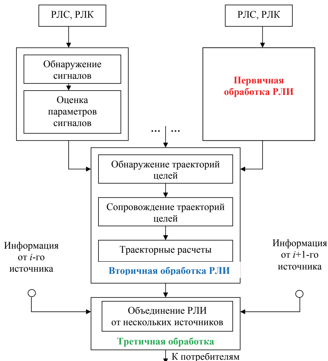
Рис. 2.5. Последовательность выполнения операций обработки РЛИ в РЛ системе
