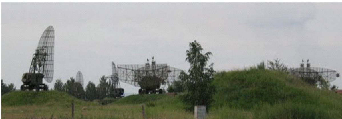
Рис. 2.2. Радиолокационный комплекс 5N87 на позиции: высотомеры ПРВ-13 (кабины В-1, В-2), дальномеры (прицепы Д-1 и Д-2)
