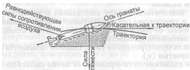
Рис. 10. Действие силы сопротивления воздуха на полет гранаты
