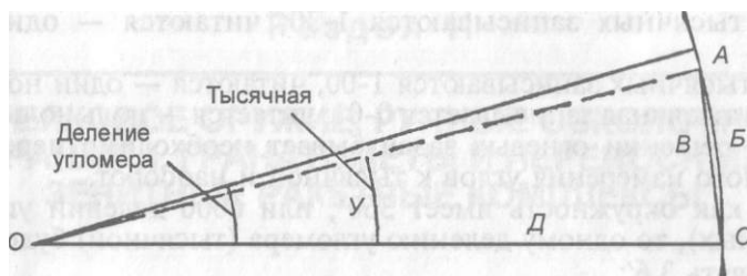
Рис. 50. Деление угломера и тысячная: АВС — дуга; АС — хорда
