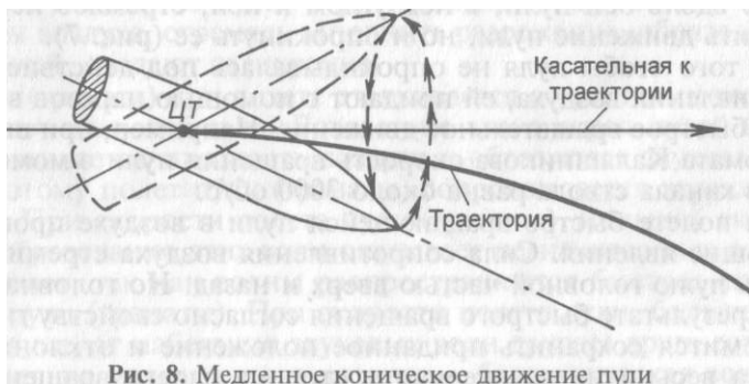
Рис. 8. Медленное коническое движение пули
