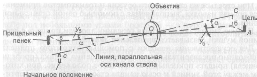
Рис. 14. Прицеливание (наводка) с помощью оптического прицела: aO — прицельная линия; cO — линия, параллельная оси канала ствола; \alpha — угол прицеливания; U_b — угол боковой поправки
