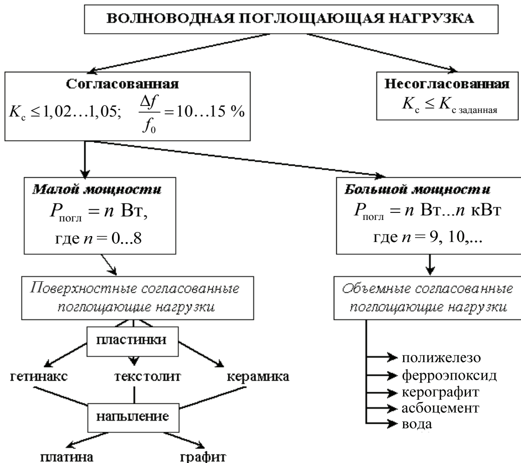
Рис. 2.39. Классификация и принцип функционирования поглощающих нагрузок
