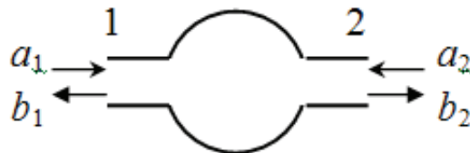
Рис. 1.3. К определению матрицы рассеяния для четырехполюсника СВЧ
