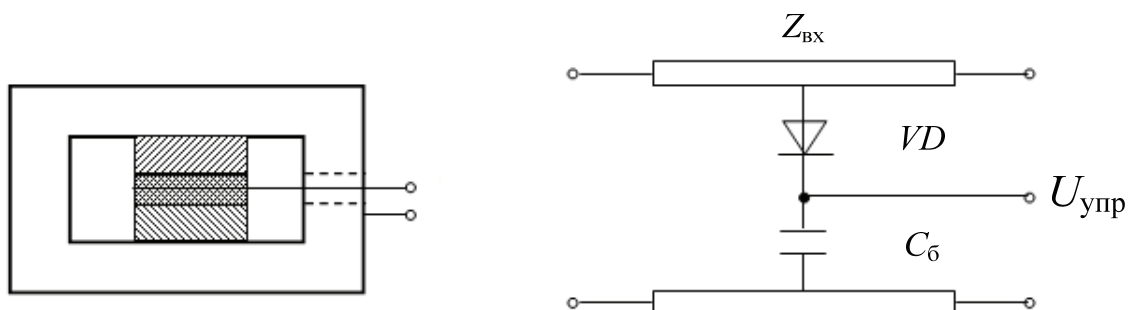
Рис. 2.35. Типичная конструкция переключающего полупроводникового диода и эквивалентная схема для прямоугольного волновода с волной H_{10}
