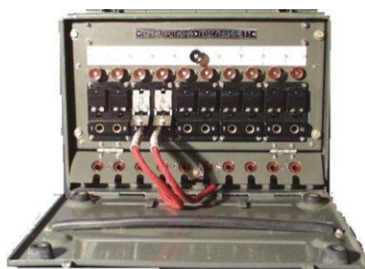
Рис. 3.8. Полевой телефонный коммутатор П-193
