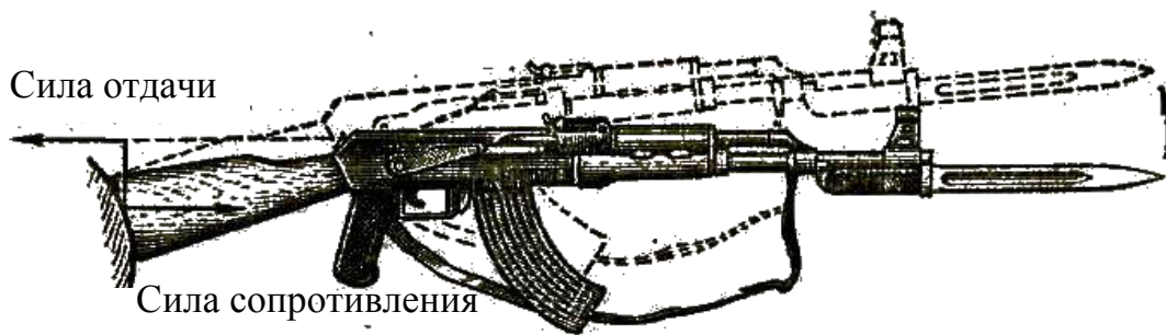
Рис. 6.6. Подбрасывание дульной части ствола оружия при выстреле в результате действия отдачи
