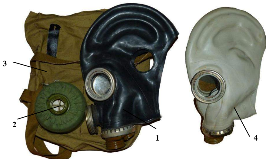
Рис. 11.3. Противогаз ПМГ-2: 1 – шлем-маска ШМ-66Му; 2 – фильтрующе-поглощающая коробка ЕО-62к в чехле; 3 – сумка; 4 – шлем-маска ШМ-62
