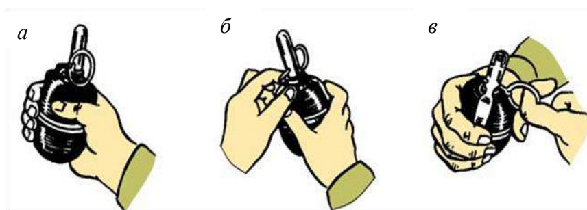
Рис. 7.46. Действия перед метанием ручной осколочной гранаты: а – прижатие спусковой скобы к корпусу гранаты; б – выпрямление концов предохранительной чеки; в – выдергивание предохранительной чеки
