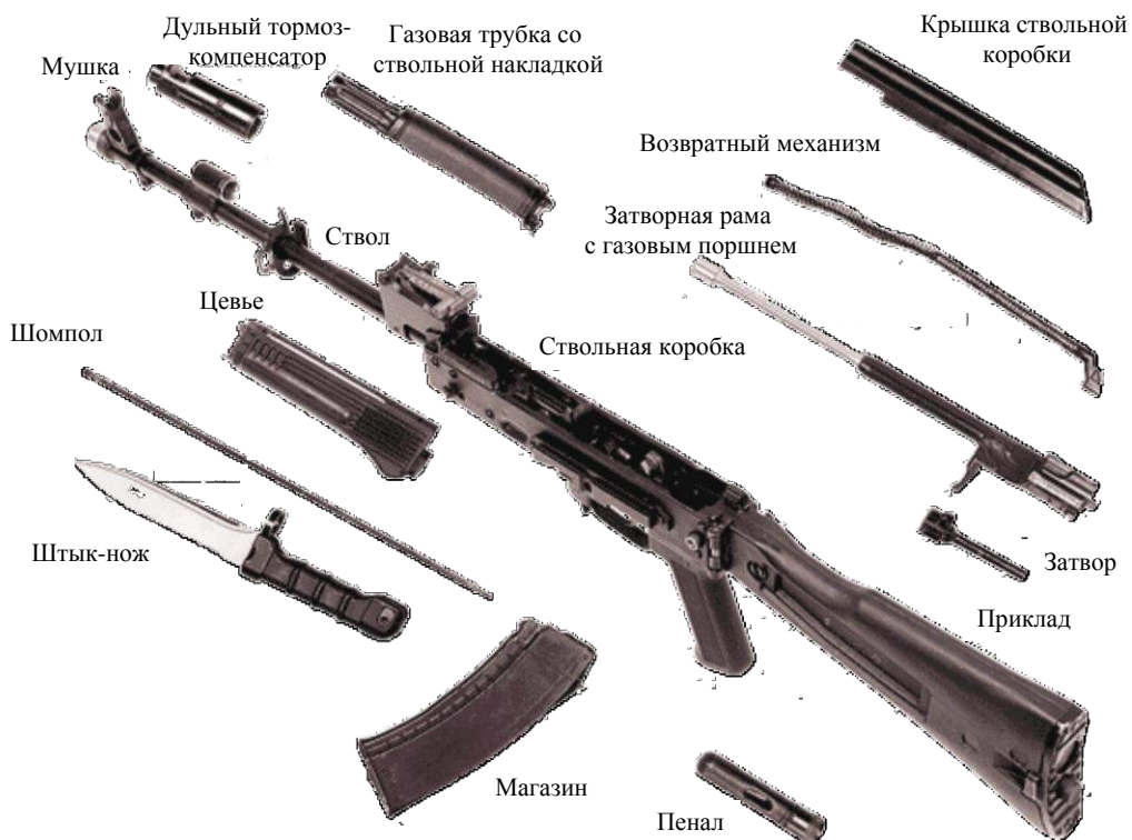
Рис. 7.9. Части и механизмы автомата АК-74М
