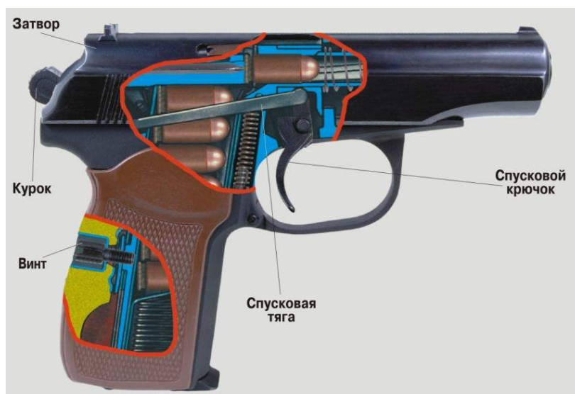
Рис. 7.26. Положение частей и механизмов пистолета ПМ перед выстрелом в момент спуска курка с боевого взвода
