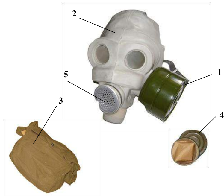
Рис. 11.2. Противогаз ПМГ: 1 – фильтрующе-поглощающая коробка ЕО-18к (ЕО-62к) в чехле; 2 – шлем-маска ШМГ; 3 – сумка; 4 – незапотевающие пленки; 5 – мембраны переговорного устройства
